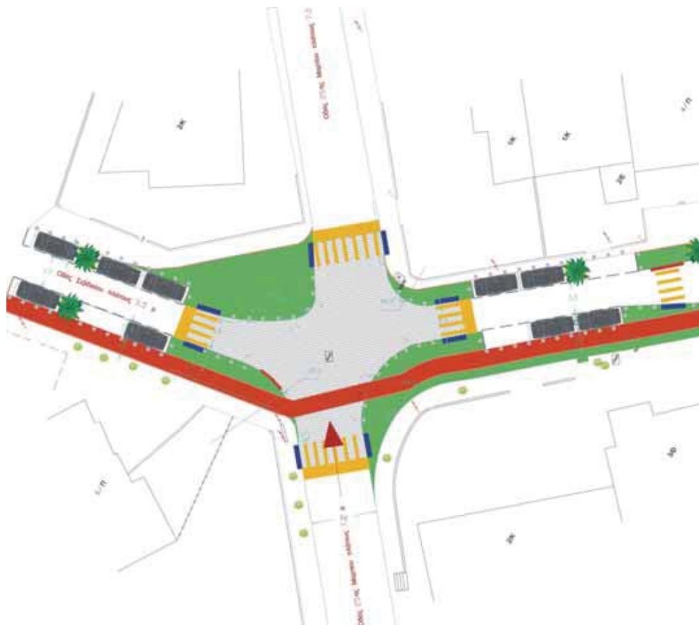
Νέα Ερυθραία. Δ Διαμόρφωση κόμβου με τοπική υπερύψωση στην τομή των οδών 25 ης Μαρτίου και Σεβδίκιου (υλοποιημένο σχέδιο της Μονάδας Βιώσιμης Κινητικότητας του ΕΜΠ).
