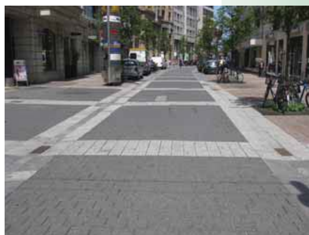
Φρανκφούρτη. Διαμόρφωση δρόμου σε ήπιας κυκλοφορίας με ενιαία στάθμη για όλους τους χρήστες
