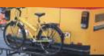
Ελβετία. Ειδική σχάρα στα λεωφορεία για την τοποθέτηση των ποδηλάτων. Πηγή: 'Bicycles and Public Transport - Towards common strategies and measures', ECF, Brussels, 2002, σελ. 27
