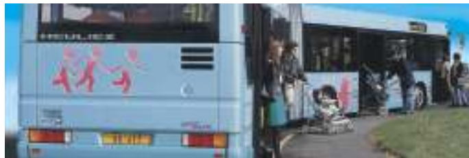
Αρθρωτό μεγαλεωφορείο χαμηλού δαπέδου
